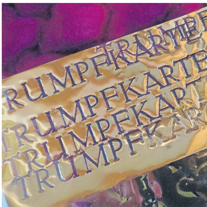
Legt die Buchbinderin ein Stück Blattgold mit in die Kniehebelpresse, so entsteht die goldene Schrift auf einem Einband.
