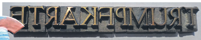
Die Buchstaben werden in eine Kniehebelpresse gespannt und erhitzt. Der Ledereinband wird unter die Presse gelegt und so die Buchstaben in das Leder geprägt.
